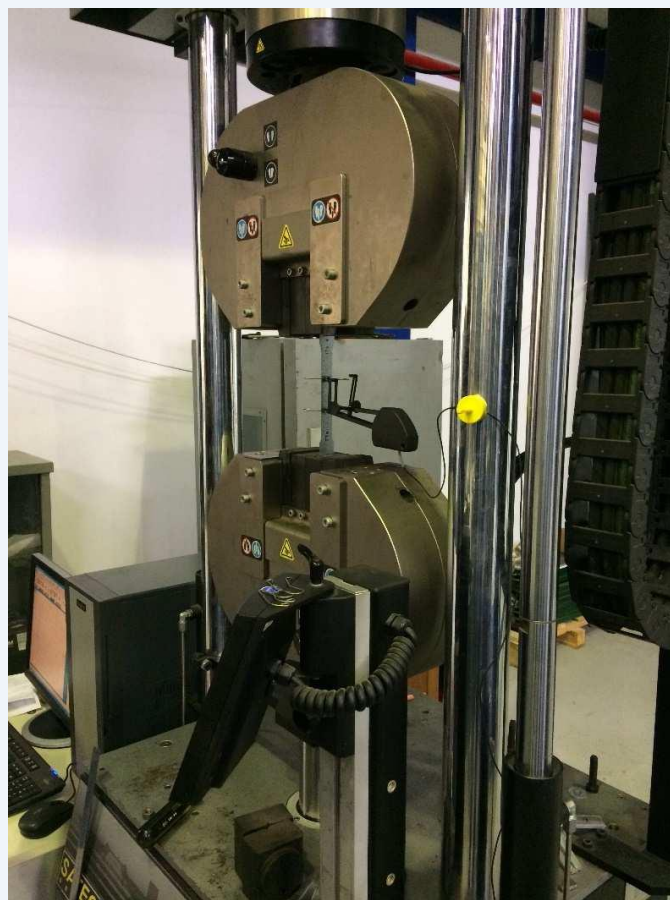
Πειραματική διάταξη δοκιμών εφελκυσμού αλουμινίου
