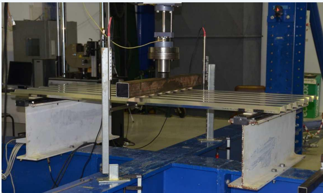
Πειραματική διάταξη δοκιμών με ενδιάμεση στήριξη
