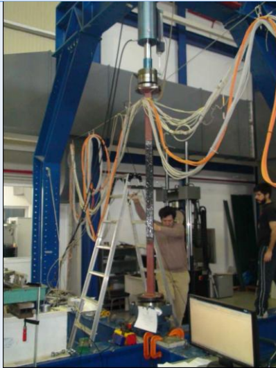
Σχ. 3: Δοκιμές λυγισμού σε υβριδικά υποστυλώματα από γωνιακές διατομές
