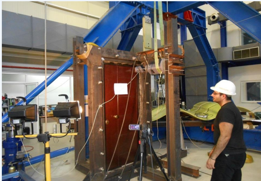
Δοκιμές υπό στατική φόρτιση σύμφωνα με το EN 1628
